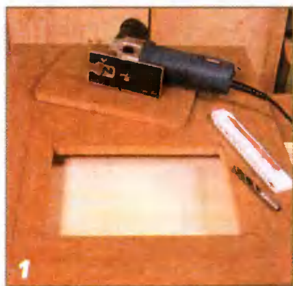
1 Чтобы фреза во время работы не перегревалась, в шаблоне вырезают участок, создающий «фронт работ» при фрезеровании заготовки для подноса.
