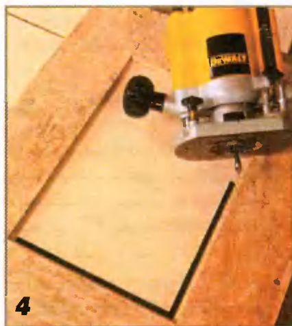
4 Заготовку вставляют в шаблон. Сначала фрезой делают прорезы на одной стороне заготовки, затем — на другой.
