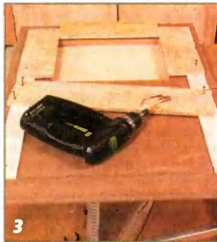
3 Сверху к упорным брускам шаблона крепят еще четыре доски в качестве направляющих для фрезерной машинки.
