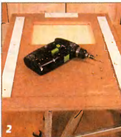
2 С трех сторон к шаблону крепят шурупами упорные бруски для фиксирования заготовки.
