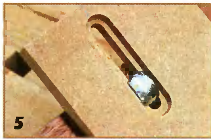
5 Вставляют болты в пазы шаблона, утапливают их головки.
