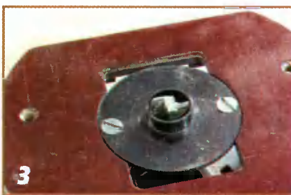
3 Устанавливают на фрезер направляющую втулку и фрезу.
